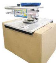
海綿多孔吸盤，適用多種尺寸， 吸力200kg，可自動關閉未貼合 工件的吸盤。
