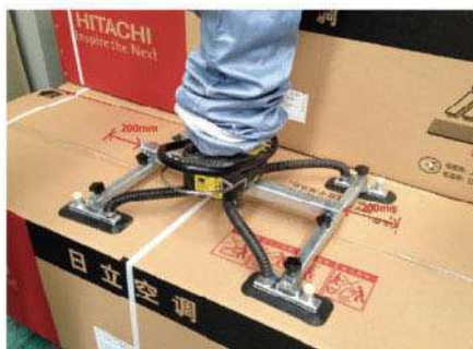
4腳矩形吸盤吸附80Kg室外機包裝箱， 吸盤可壓在打包帶上而不漏氣。
