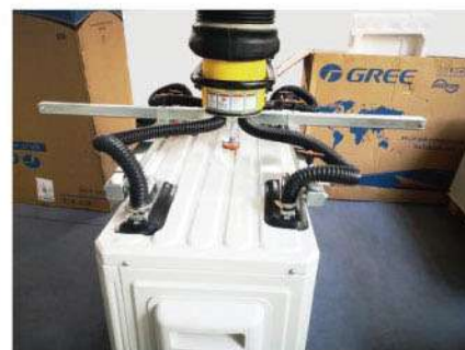
訂製4腳吸盤，吸附室外機，可適應 凹凸表面，最大吊重80kg。
