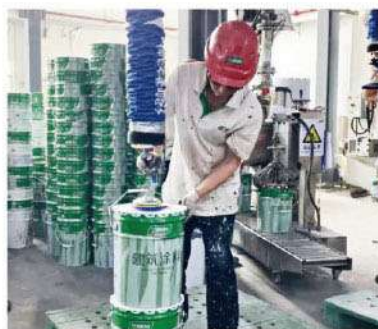
直徑200mm或270mm的吸盤可以吸附20-60Kg油漆桶。訂貨號816410
