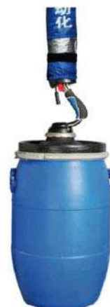
特製的直徑554mm的吸盤，可用於吸附270kg的鐵桶或塑膠桶。
