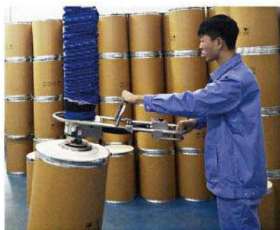
1個直徑200mm吸盤，一次吸附60kg潤滑油桶。
