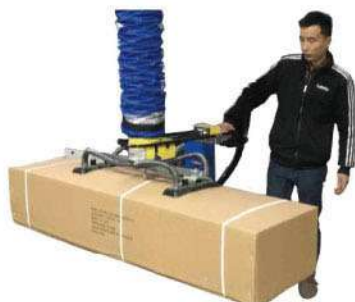
雙腳吸盤適用於有打包帶的紙箱。
