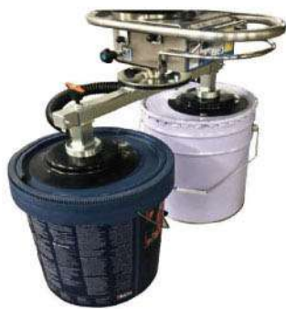
2個直徑200mm吸盤，吸附2個油桶，並且符合防爆要求EXII-BT4。
